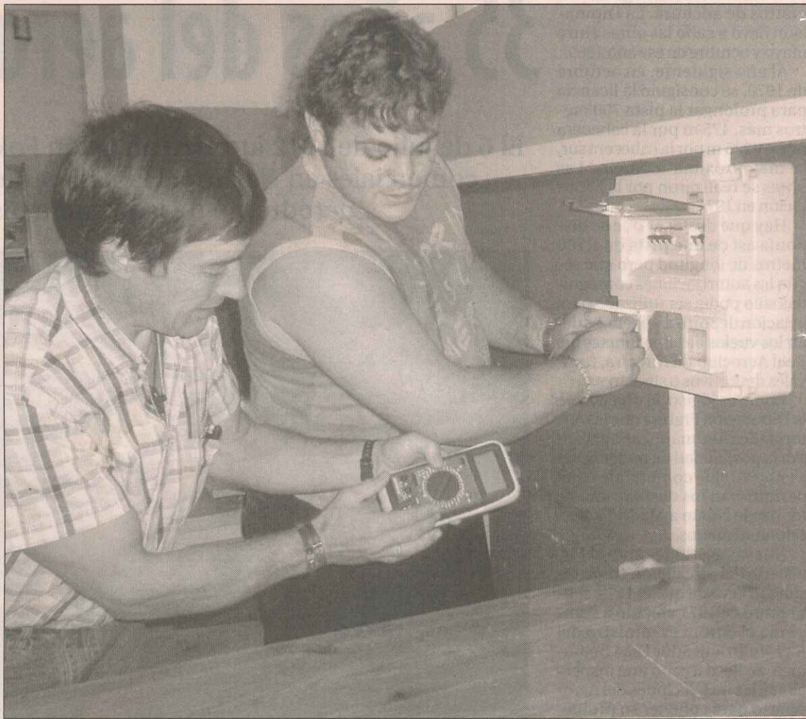
Toni Fagundes y Juan Manuel Iribarren comprueban con un polímetro el estado de un cuadro eléctrico.
